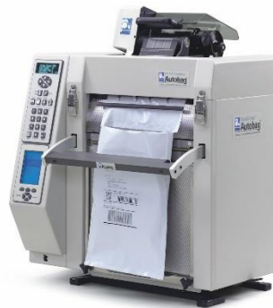
Maquina Autobag Reenvasado de medicamentos
